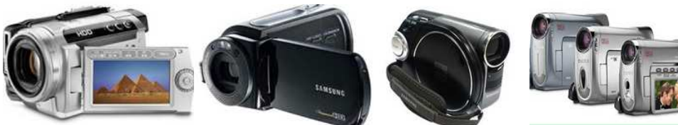
شکل ۱-۱۸. از راست به ترتیب: مینی دی‌وی، مینی دی‌وی‌دی، با حافظه فلش و با حافظه هارددیسک
